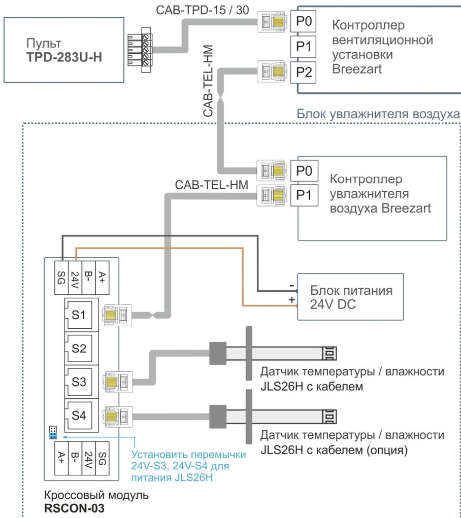
**Вариант 2.** Если к увлажнителю требуется подключить только один датчик, то его можно подключить непосредственно к порту P1 увлажнителя.
