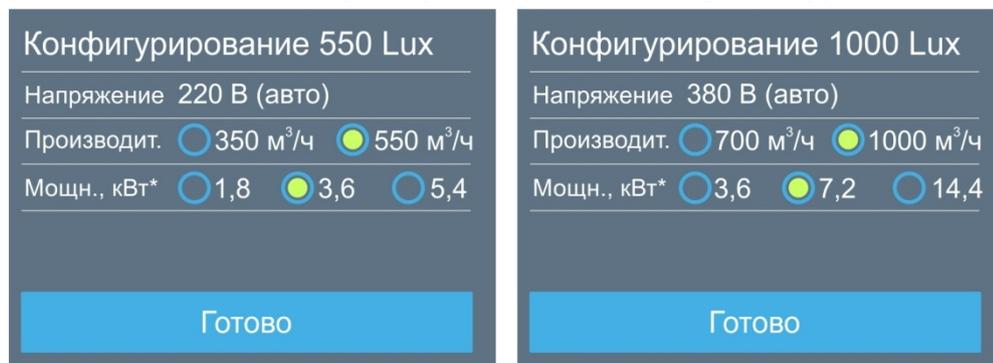
Напряжение питания калорифера (380В / 3 фазы или 220В / 1 фаза) выбирается автоматически в зависимости от типа электропитания вентустановки.
