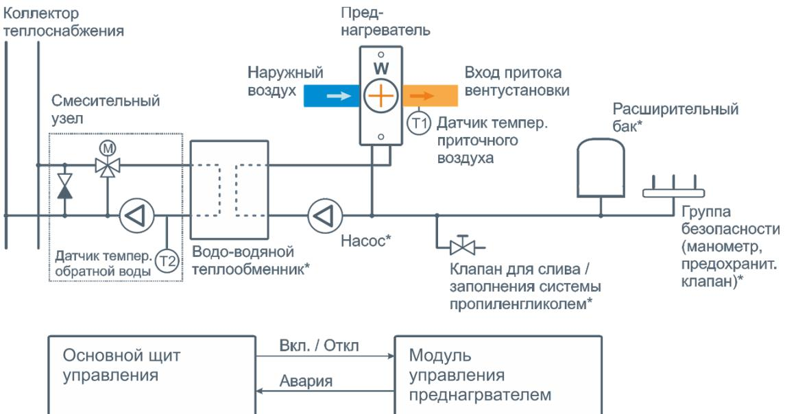
Схема подключения дополнительного водяного калорифера для преднагрева воздуха на входе в вентустановку (для регионов с холодным климатом). В состав опции PW входят:
