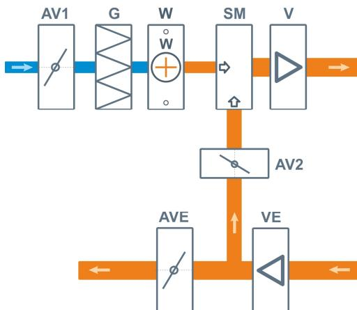
\* На схемах для упрощения не показаны датчики и другие вспомогательные элементы. Полная структурная схема вентиляционной установки приведена в документации.
