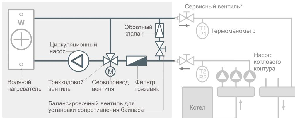
\* Сервисные вентили должны подключаться к смесительному узлу при помощи соединителей типа «американка» для того, чтобы была возможность демонтажа вентустановки.
