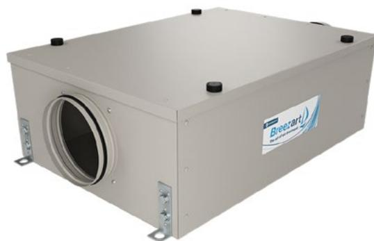
Вентустановка выпускается в двух модификациях: люк обслуживания может быть сбоку или снизу (версия SB – для подпотолочного размещения). В обеих модификациях воздушный клапан размещен снаружи корпуса, что улучшает его ремонтпригодность и позволяет выносить клапан с приводом к месту забора наружного воздуха (врезка для замещения клапана прилагается).
