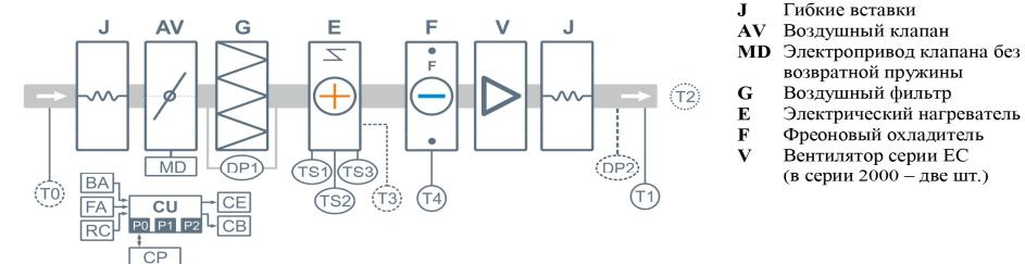
\* К порту Р0 можно подключить одно из устройств управления (штатный пульт CP-ST, USB-адаптер BSA-02 для связи с компьютером).
